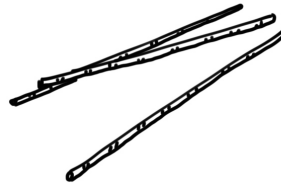
میلگردهای فولادی: اندازه استاندارد، فولاد آج‌دار، فولاد AIII، نو و بدون خوردگی
